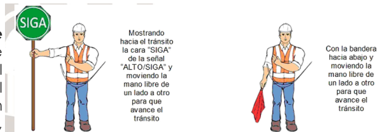
FIGURA 5.- Para que avance el tránsito
