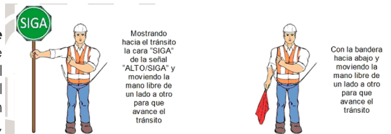
FIGURA 5.- Para que avance el tránsito
